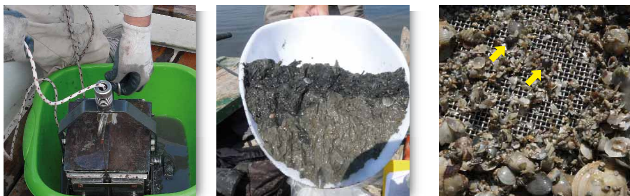
Fig. 3.2 - Diverse fasi del campionamento del fondale di una zona umida (foto F. Borghesi); il sedimento viene prima raccolto con una benna, successivamente estratto e setacciato. Nell'immagine di destra le frecce indicano due pallini di piombo.
